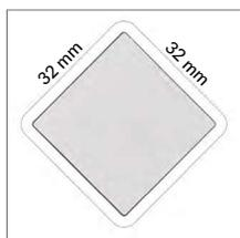
**Parte superiore della gamba in tubo profilato decapato a sezione romboidale 32x32 mm, in spessore 2 mm.**
