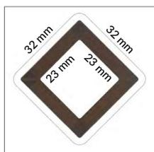
**Gamba in tubo profilato decapato a sezione conica romboidale sezione iniziale 32x32 mm (finale 23x23 mm), in spessore 2 mm.**
