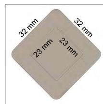
**Parte inferiore della gamba in legno di frassino essiccato a sezione conica romboidale (sezione iniziale 32x32 mm, finale 23x23 mm).**
